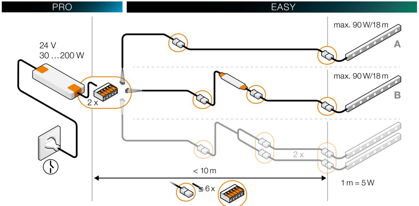
**Hinweis:** Max. Länge der aneinandergereihten LED-Module im LIPROTEC-EASY-System bei Einsatz des Plug & Play-Adapters: 18 m je Kabelstrang (A oder B) in Abhängigkeit vom eingesetzten Netzteil.
