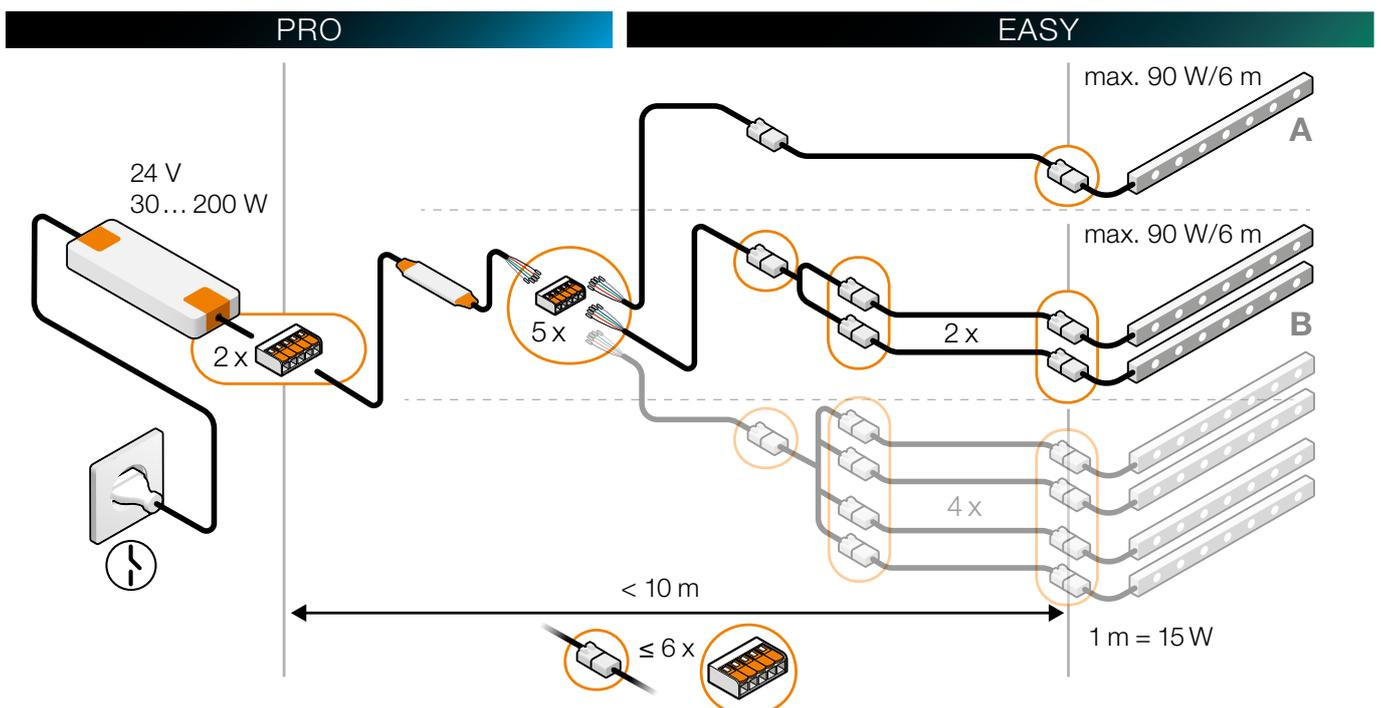
**Hinweis:** Max. Länge der aneinandergereihten LED-Module im LIPROTEC-EASY-System bei Einsatz des Plug & Play-Adapters: 6 m je Kabelstrang (A oder B) in Abhängigkeit vom eingesetzten Netzteil.
